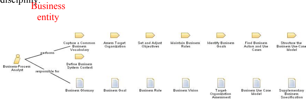
Obr. 6-4: Aktivity a artefakty přiřazené roli Business Process Analyst disciplíny Business Modeling (zdroj [RUP large]).
