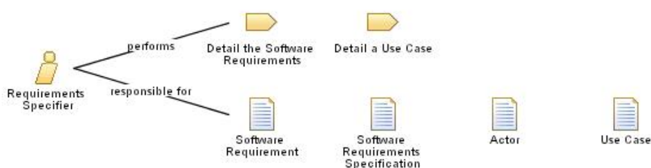
Obr. 6-8: Aktivita a artefakty přiřazené roli Requirements Specifier disciplíny Requirements (zdroj [OpenUP]).
